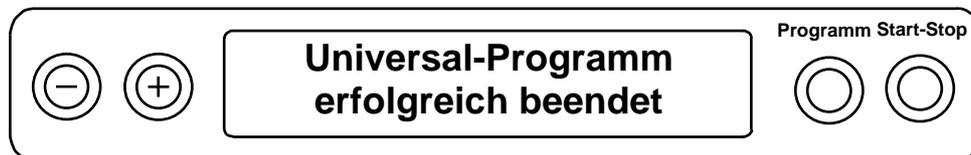
mit den erreichten Maximalwerten für Druck und Temperatur. Bei angeschlossenem Drucker und gewählttem "Sofortausdruck ja" erfolgt gleichzeitig ein Protokollausdruck.
